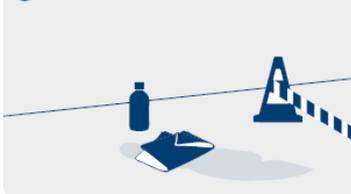
Signalez la zone à protéger durant les travaux. Évacuez les poussières à la surface du sol. Séchez le sol si besoin. Dégraissez les sols en intérieur.
